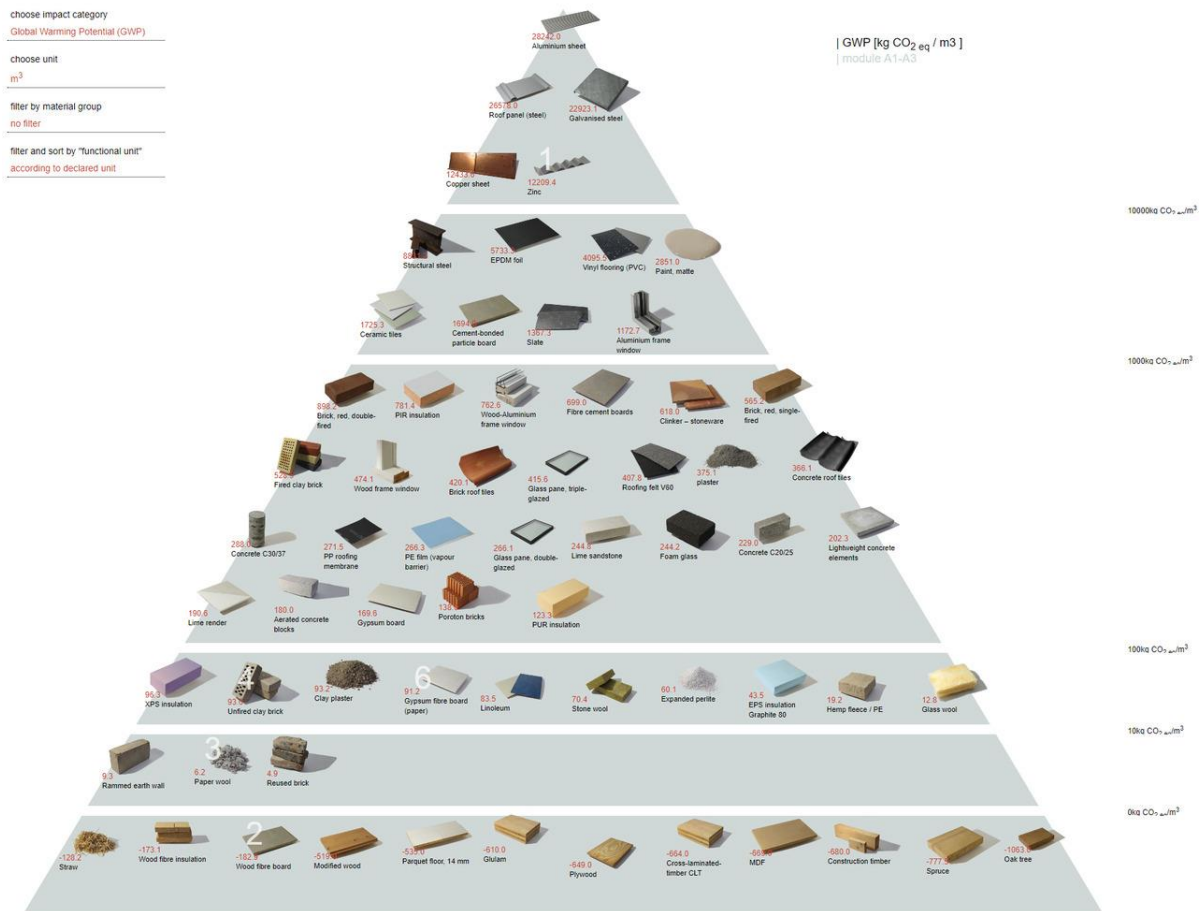
Figura 12: Pirámide del impacto ambiental de los materiales de construcción. Fuente: Centre for Industrialised Architecture (CINARK) from Royal Danish Academy.
