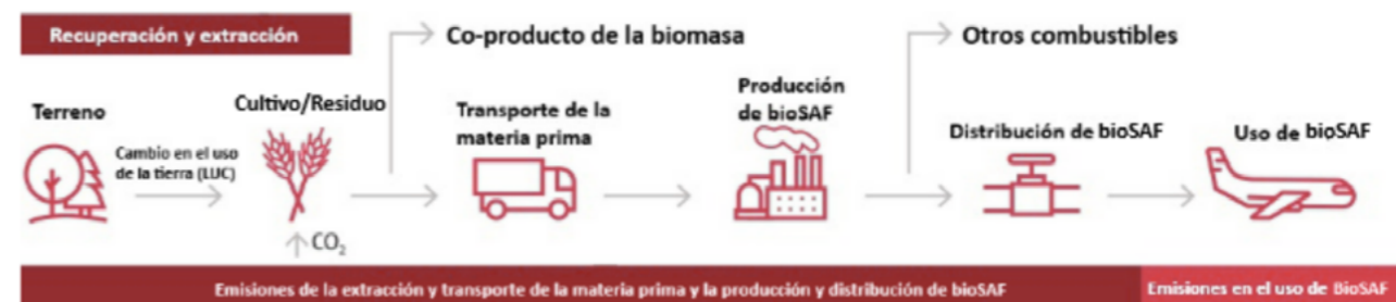
Figura 8. Elementos típicos del ciclo de vida de las emisiones del biocombustible de aviación. Fuente: Adaptado de EASA.
